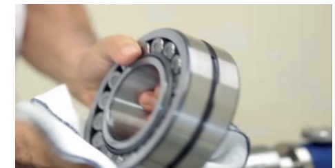
Atenção: Rolamentos novos devem ser retirados de sua embalagem somente no momento da montagem
